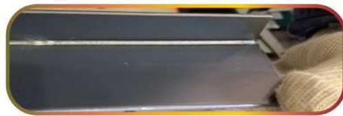
ファイバーレーザー溶接は、TIGレーザー溶接よりも溶接による焼けや歪みが少なく、高品質な溶接ができます。熱による歪みが発生しやすい薄板の溶接も歪みが少なくきれいに溶接ができます。また、溶接スピードが速いので作業時間を短縮でき、より多くの部材を溶接できるようになりました。ステン板・鉄板の0.3mm～6mmまで溶接可能です。新しい溶接機で製品品質の向上に努めてまいります。
